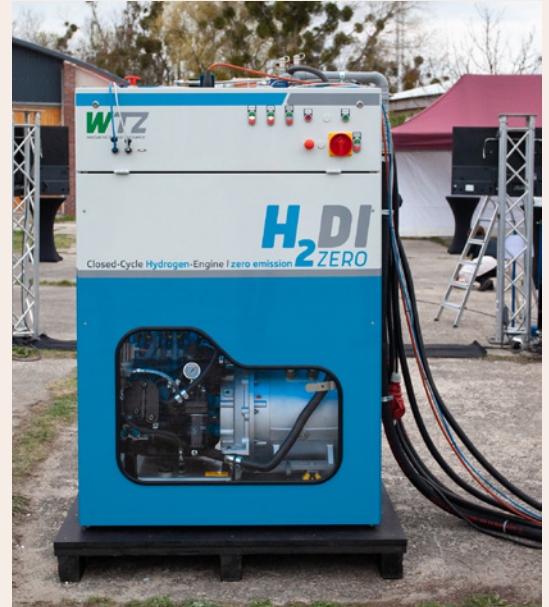
► Bild 4: Vorstellung des neu entwickelten Wasserstoff-Sauerstoff-Kreislaufmotors (Zero-Emission-Kreislaufmotor) auf der 11. Dessauer Gasmotoren-Konferenz (Bildquelle: WTZ Roßlau gGmbH)
